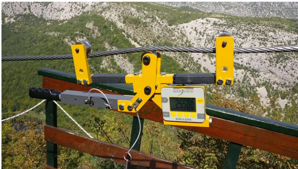
1. 1 - 6 Prikaz zateznog mehanizma ZIP line-a (Izvor: Arhitektonski projekt)
